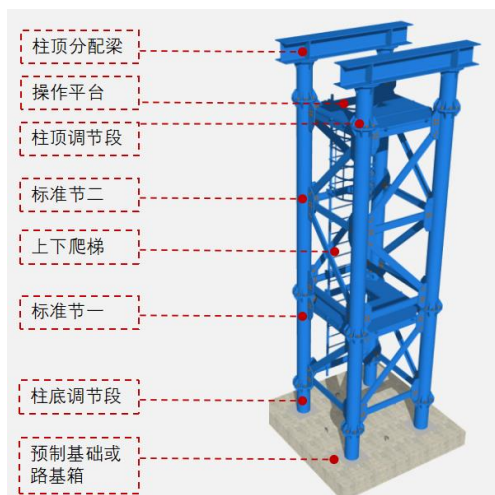
图 4-1 装配式承重支架三维图
